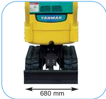
Gesloten chassis om eenvoudig toegang te krijgen tot smalle ruimtes.
