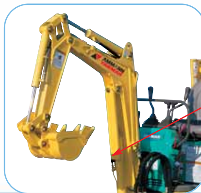
Beveiliging op de cilinderstang van de giek.
