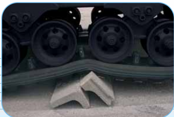
Galets tandem avec mouvement pendulaire
